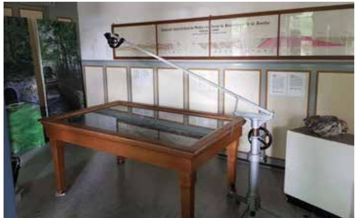
Abb. 28: Fahrbares Stativ mit Ausleger für Kameraaufnahmen von oben, hier bei der Aufnahme der Tischinstallation des Oberharzer Gangbergbaus. (© Foto: W. Hannemann/TU Clausthal)
