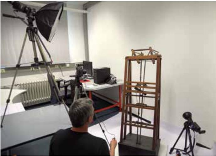
Abb. 23: Aufnahmesituation im Labor am Beispiel der Rosenhöfer Fahrkunstversicherung. Drehbare Positionierung des Modells mit Beleuchtung durch Softbox (im Bild oben links) und gekoppelter Hintergrundaufleuchtung. (© Foto: T. Schäfer/TU Clausthal)
